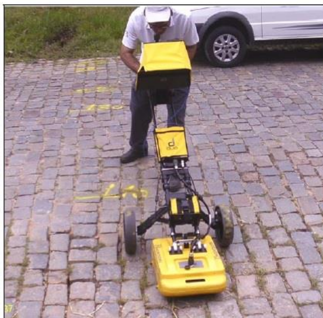
Figura . – Equipamento GPR ( DetectorDuo ) utilizado nos levantamentos, com antenas blindadas de frequências distintas (250 e 700 MHz).
